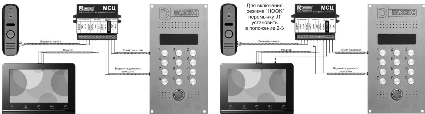
При подключении по правой схеме, не забудьте перевести перемычку J1 в положение 2-3, при этом назначение клеммы 10 переключится из GND во вход сигнала HOOK. Общий провод сигнального кабеля подъездного видео нужно подключать к любой другой клемме GND (2 или 6) в такой конфигурации. Данная схема подключения действительна только для модулей сопряжения МСЦ версии 1e и выше.
